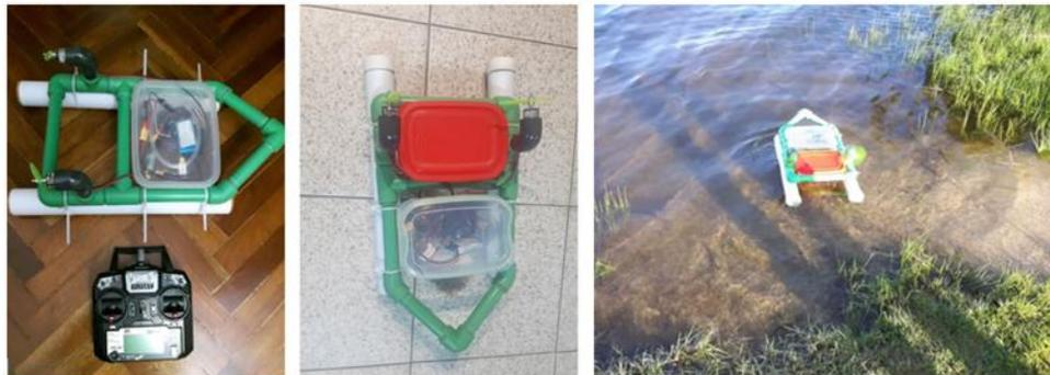
**Figura 19** Barco controlado remotamente com sistema de recolha de água para análise.
