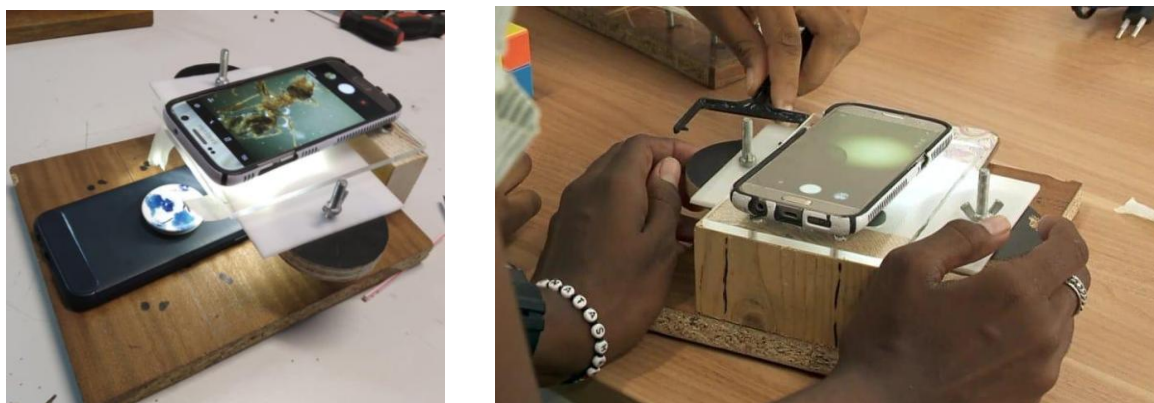
Figura 4 Microscópio feito de material reutilizado
