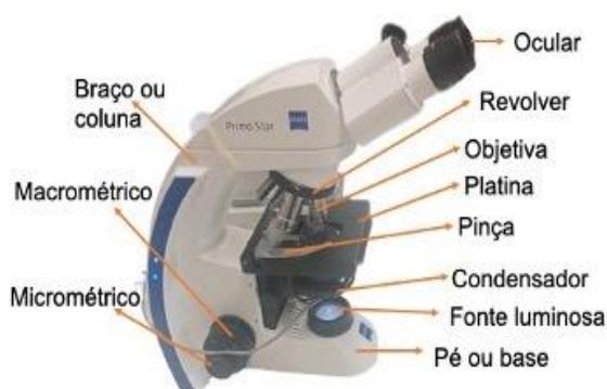
**Figura 1** Microscópio ótico composto (fonte: foto de autoria dos autores)
