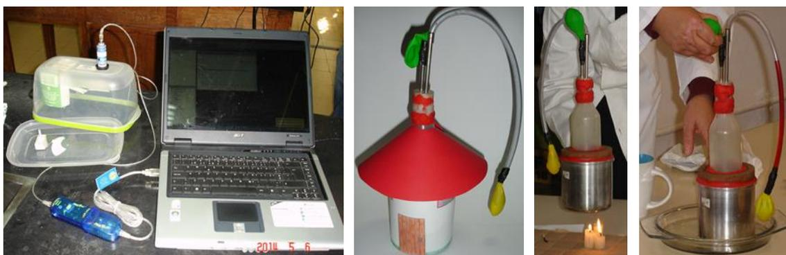
**Figura 9** Montagem experimental para medir a concentração de oxigénio durante a combustão e instrumento que permite verificar a dilatação e contração do ar.
